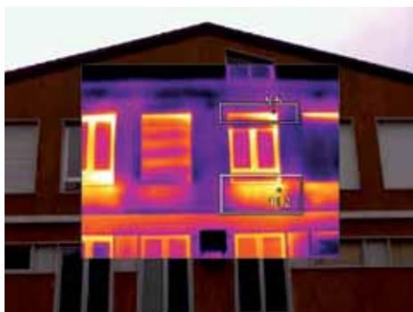
1 – Nel riquadro a sinistra è visualizzabile, grazie alle differenze cromatiche, il comportamento del parapetto sollecitato, dall'interno, da un calorifero acceso posto sotto la finestra. Nell'area sovrastante vediamo la perdita nei serramenti caratterizzate sempre da colori caldi (temperatura esterna  $-5^{\circ}\text{C}$ )
