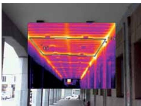
4 – Nell'immagine del portico è stato circoscritta l'area che riporta l'orditura di una parte del solaio dove le strutture più chiare laterali e trasversali sono le travi e i travetti. (temperatura esterna -2 °C).
